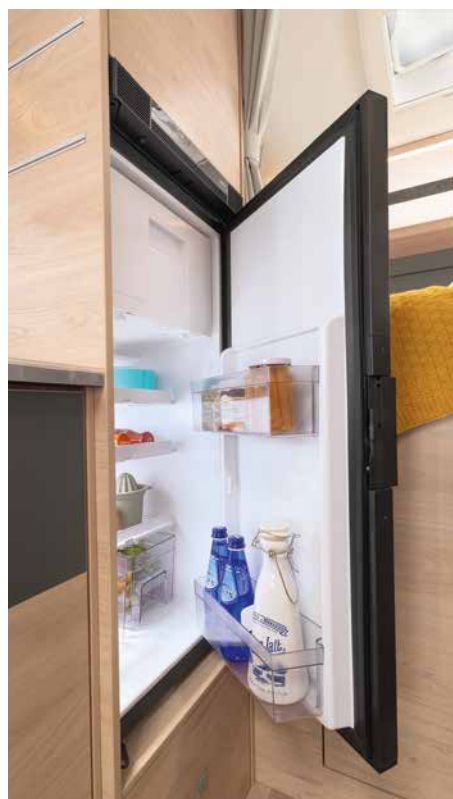
Lodówka kompresorowa o poj. 84 l z zamrażalnikiem, w standardzie. Na życzenie istnieje możliwość montażu chłodziarko-zamrażarki o poj. 149 l.
