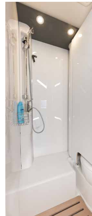
Kabina prysznicowa. W połączeniu z wyłożonymi tworzywem sztucznym drzwiami przesuwными ścianka obrotowa tworzy kabinę prysznicową, która jest w pełni zabezpieczona przed wodą. To najlepszy sposób na wykorzystanie tej ograniczonej przestrzeni.
