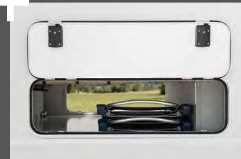
Ochrona przed mrozem: podgrzewana podwójna podłoga z dużą ilością luków bagażowych
